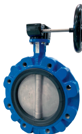
Serie 820/60 Centriskt vridspjäll med lös liner av NBR, NH liner eller FPM VD. Växel och handratt. Lug. Segjärn. DN50-400
