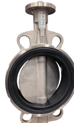
823/50-112 Centriskt vridspjäll med lös liner av NBR, NH liner eller FPM VD. Ventilhus tillverkad helt i rostfritt. Wafer. DN50-400
