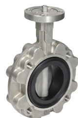
823/60-112 Centriskt vridspjäll med lös liner av NBR, NH liner eller FPM VD. Ventilhus tillverkad helt i rostfritt. Lug. DN50-400
