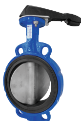
Serie 820/50 Centriskt vridspjäll med lös liner av NBR, NH liner eller FPM VD. Handspak. Wafer. Segjärn DN25-400
