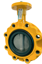
Serie 823/60 Centriskt vridspjäll med lös liner av NBR, NH liner eller FPM VD. För gas. Lug. Segjärn DN50-400
