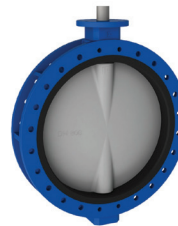
Serie 820/20 Centriskt vridspjäll med lös liner av NBR, NH liner eller FPM VD. U-shape Segjärn DN150-1600
