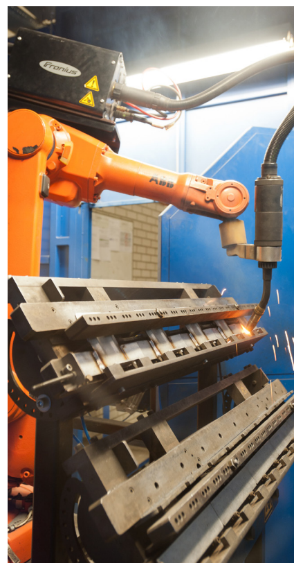
Ovan: AVK Nederland BV:s fabrik i Rewag där REPICO® tillverkas. Höger: Robotsvetsning i Rewag-fabriken
